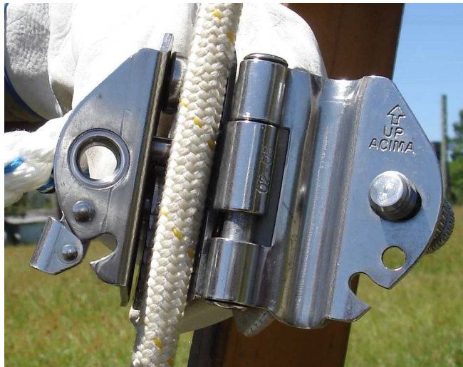
Figura 33 – Instalação do trava-quadras na linha de vida
