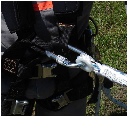
Figura 34 – Instalação do trava-quedas no cinto paraquedista
