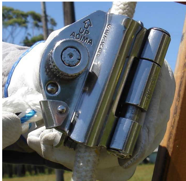
Figura 35 – Fechamento e travamento do trava-quedas
