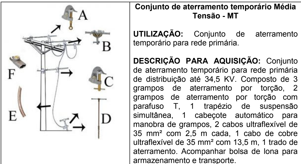
Figura 61 – Conjunto de aterramento temporário MT
